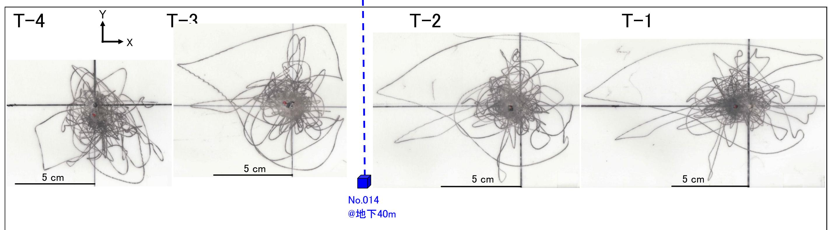
※免震装置は基礎スラブ上に設置され、層間変位計は基礎スラブとその上階のスラブとの間に設置されています。したがって、これらの記録から免震装置の水平方向の変形をることができます。
