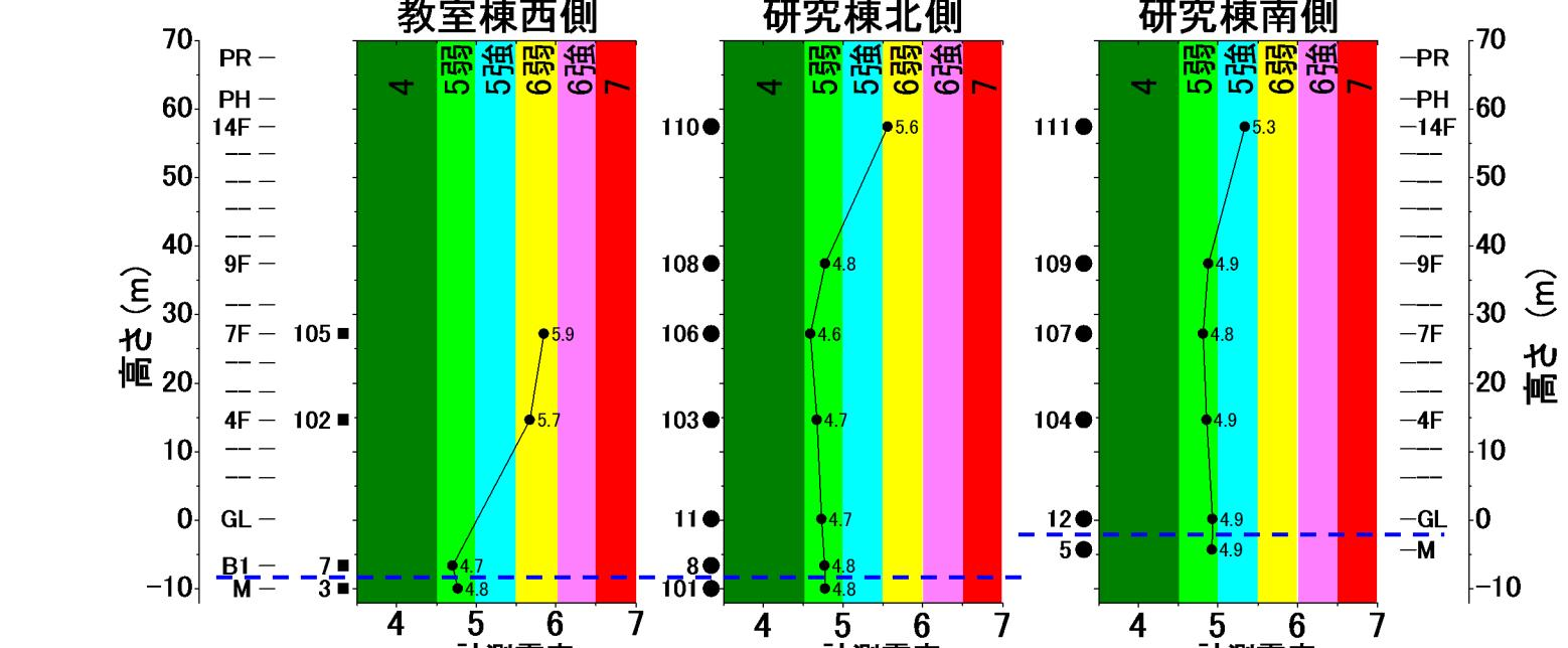
※地震計004（地下40m）の計測震度は4.2（震度4）。図中の青線より下側は免震装置より下側の結果。
